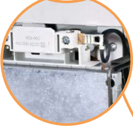
→ Vestavěný varistor (EMC filtr).
